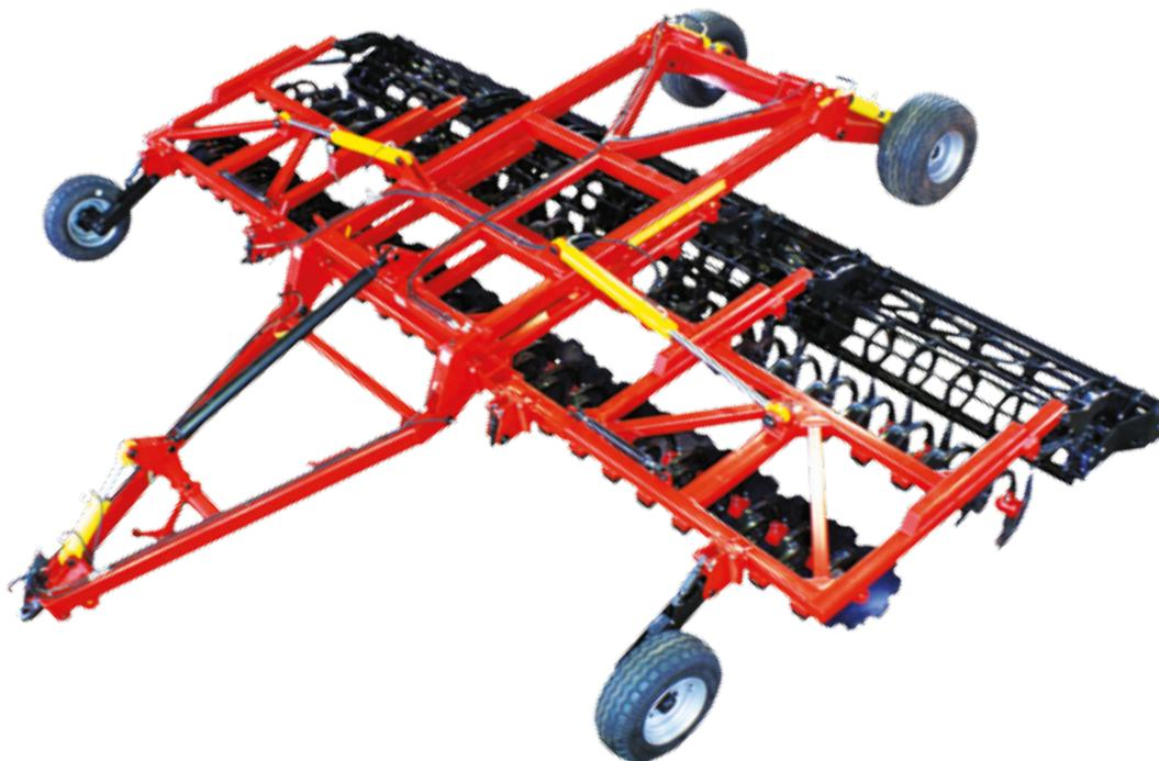
**1.** Использование дисков ромашка диаметром 610 мм позволяет увеличить глубину обработки почвы до 15 см. Мощный режущий узел идеально подходит для тяжелых Российских черноземов.
