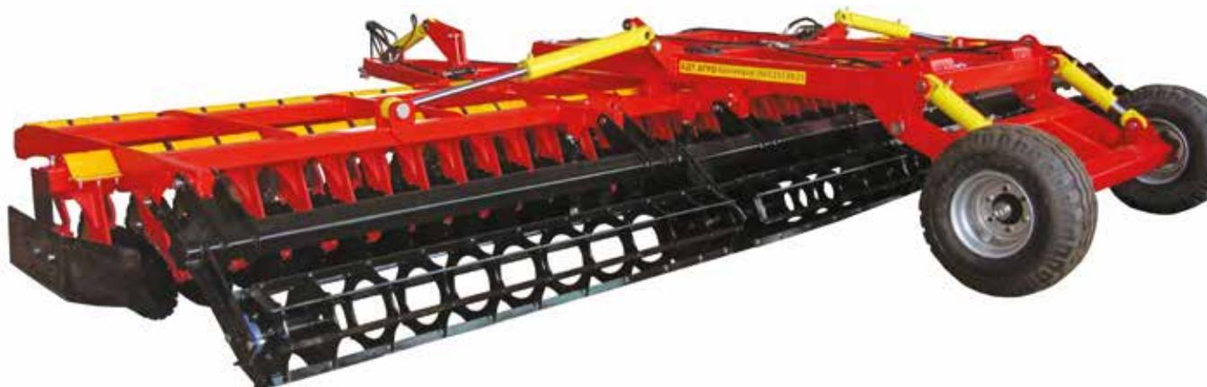
У борон дисковых БДМ-В БАРСУК при встрече с камнем или другим непреодолимым препятствием, за счет упругой деформации эластомеров, диски уходят вверх и обходят препятствие без поломок. Этот 3D эффект значительно снижает нагрузку на узел режущий и особенно на подшипники, что позволяет увеличить скорость работы и производительность орудия.
