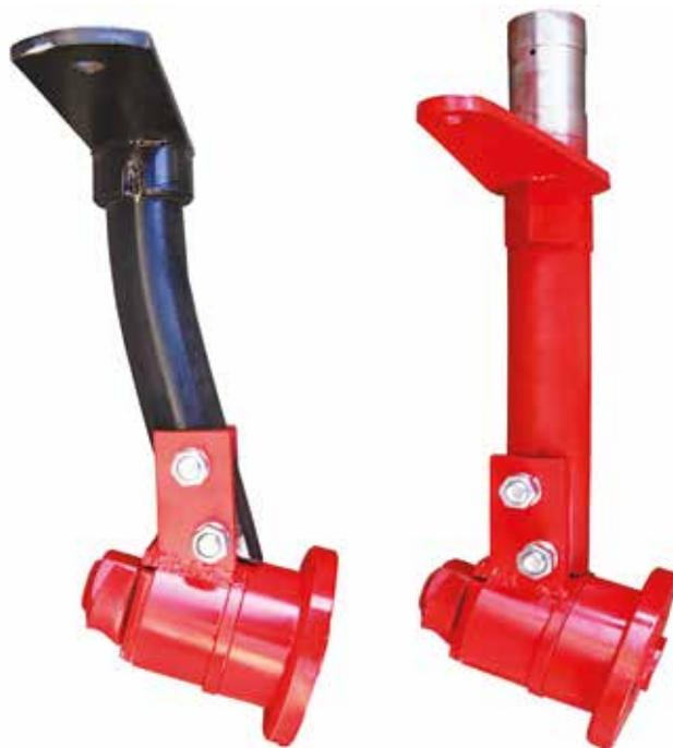
и втулкой расположены два роликовых конических подшипника. К корпусу подшипника с помощью болтов крепится режущий диск. Между режущим диском и подшипником установлена крышка с масленкой для смазки подшипника. Для защиты подшипника от грязи применяется резиновая манжета. Ось имеет резьбовую часть с лыской, и неподвижно закреплена с помощью гайки и загипсованной стопорной шайбы.
