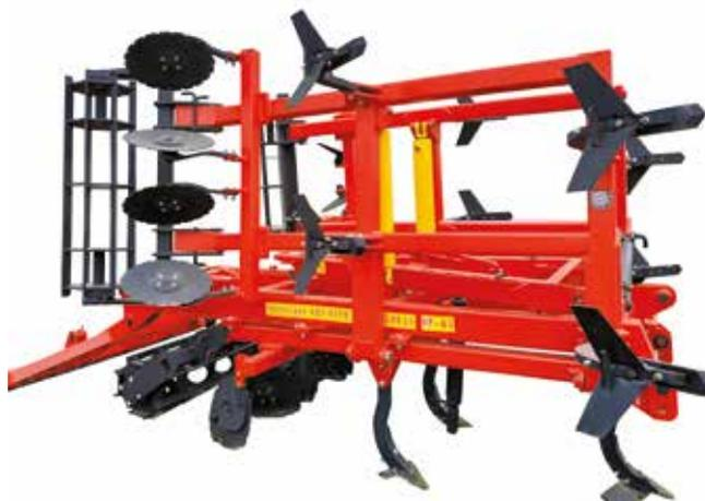
Как основная опция между основными рабочими органами и катком устанавливаются два ряда пружинных борон. Предусмотрена возможность установки дисковых загортачей.
