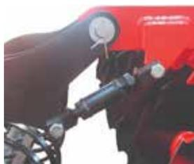
Все орудия серийно комплектуются механизмом регулировки глубины обработки (опорным катком).
