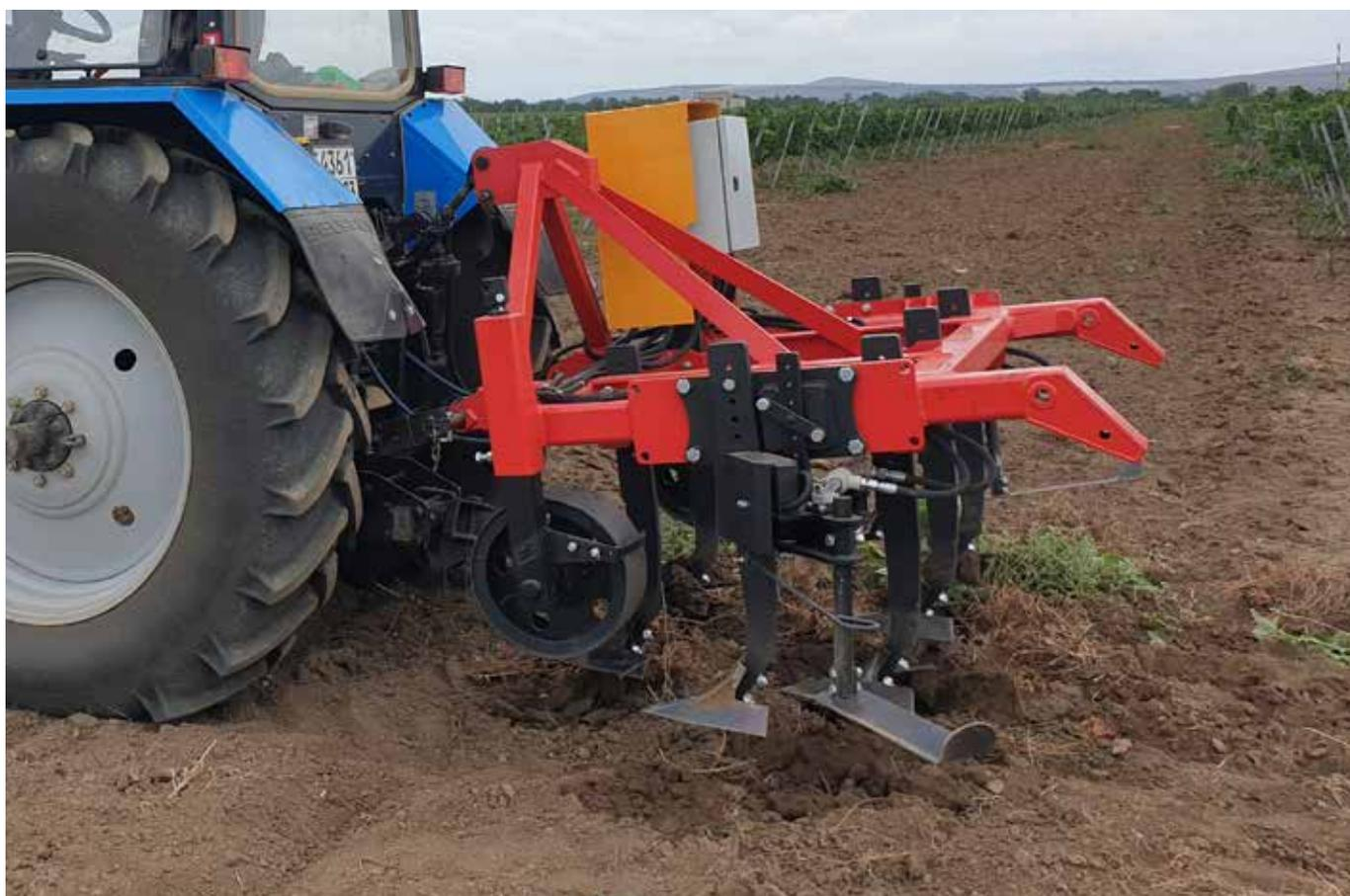
Плуги чизельные ПЧ производства БДТ•АГРО предназначены для безотвального рыхления уплотнённых слоёв почвы на глубину до 45 см, препятствующих естественным водооборотным процессам. Прямые стойки со съёмным наральником образуют щели, через которые происходит обмен влагой с нижележащим слоем почвы, что улучшает состояние поверхностного слоя.
