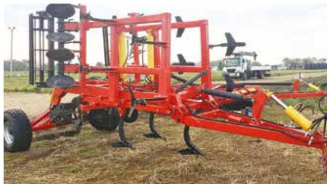
КУЛЬТИВАТОРЫ СТЕРНЕВЫЕ КР С ЗАЩИТОЙ СТОЙКИ СРЕЗНЫМ БОЛТОМ
