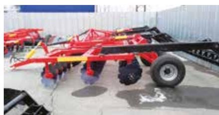
**БОРОНА ДИСКОВАЯ МОДЕРНИЗИРОВАННАЯ серии БДМ 3-х рядная (глубина обработки до 17 см)**
