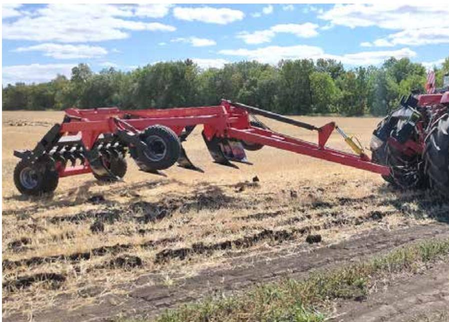
Этому способствует мощное долото квадратного сечения, которое образует на глубине 45 см долго не зарастающую кротовину.
