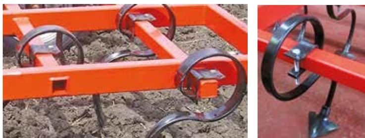
КСУ: из 60 мм трубы. За счет рациональной расстановки S-образных стоек в четыре ряда удалось исключить забивание культиватора сорняками и пожнивными остатками. На КСП установлены стойки сечением 32x12 мм, на КСУ: 65x12 мм.
