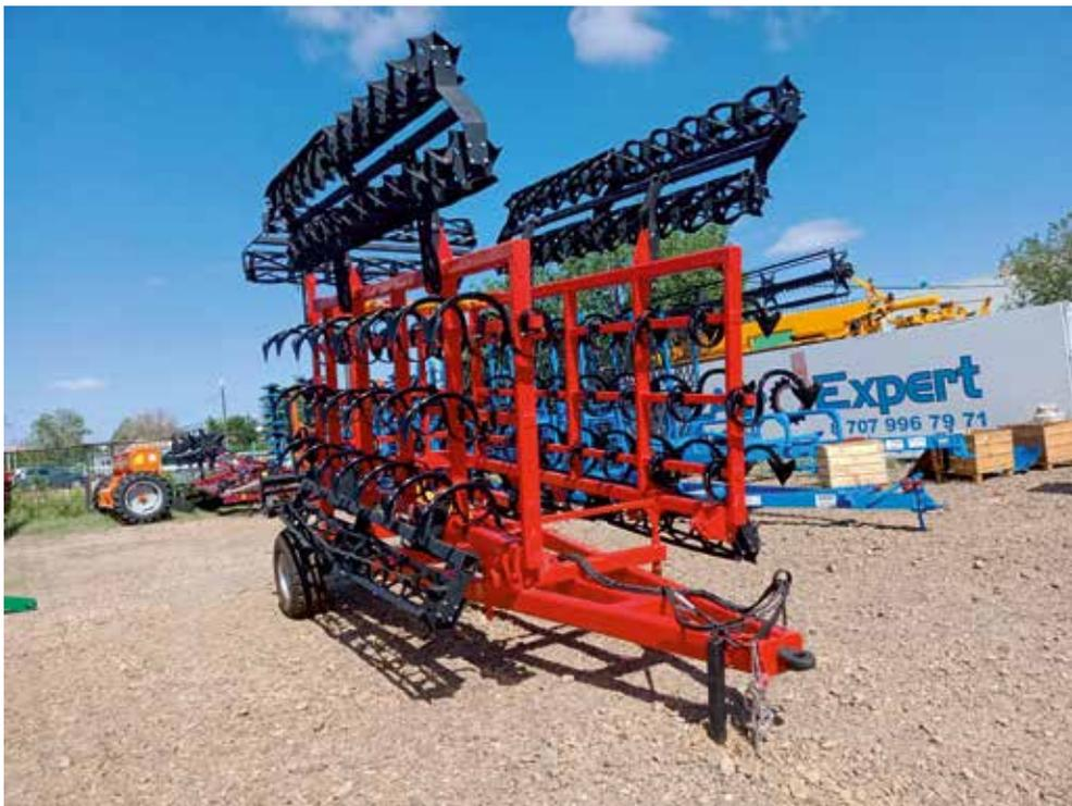
Культиватор универсальный КПД ВИТЯЗЬ®-Евро предназначен для поверхностной обработки почвы на глубину до 12 см, уничтожения сорняков, выравнивания и рыхления поверхности поля и создания ровного посевного ложа.
