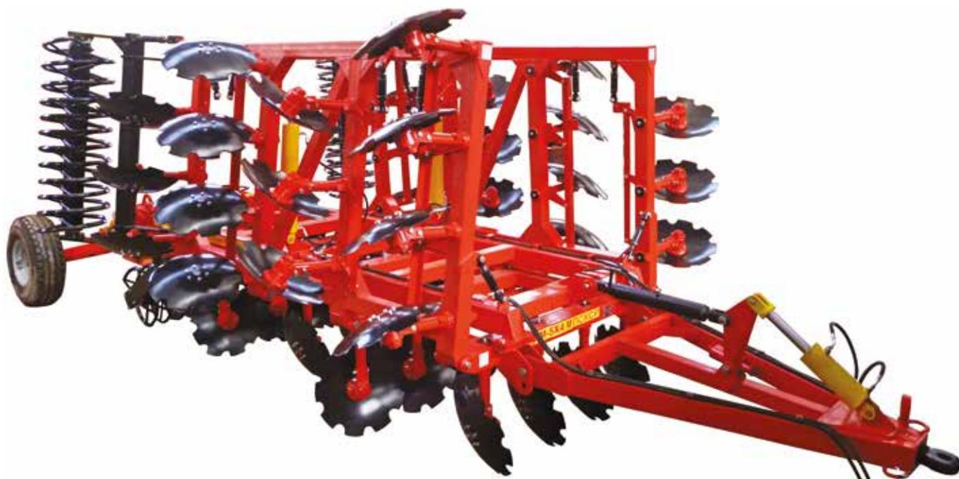
Многофункциональность достигается за счет того, что модульная борона содержит продольную и поперечную раму. Прицеп, продольная рама и шасси образуют несущий продольный модуль, а поперечная рама с рабочими органами и прикатывающими катками образует модуль. Модуль «подвешивается» снизу к несущему модулю с помощью фланцев и болтового соединения.
