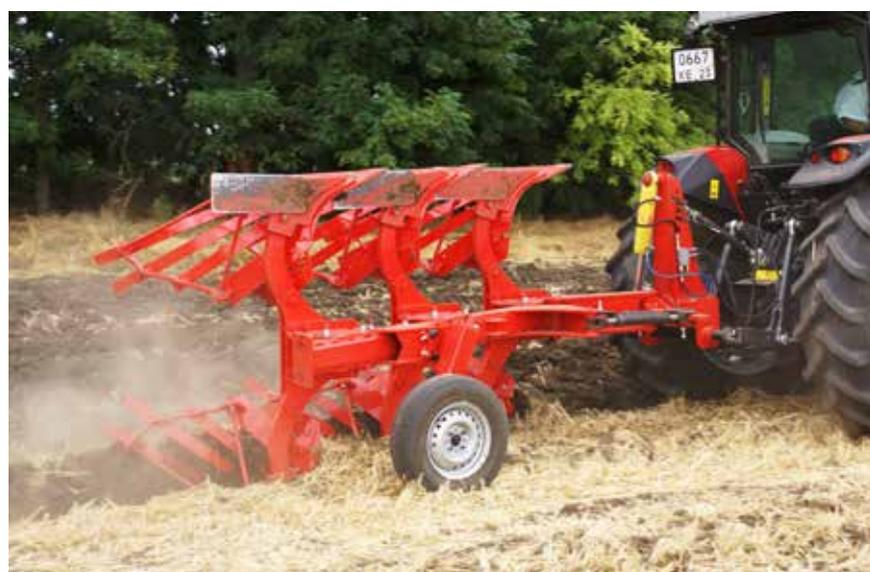
Большое расстояние между корпусами и специфическая форма стоек корпусов обеспечивает большое свободное пространство. Тем самым гарантируется работа без забивания рабочих органов. Все корпусные стойки оснащены предохранительными срезными болтами.
