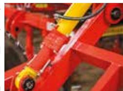
Вынос шасси за пределы рабочей части орудия позволил на невыровненных полях выдерживать заданную глубину обработки.
