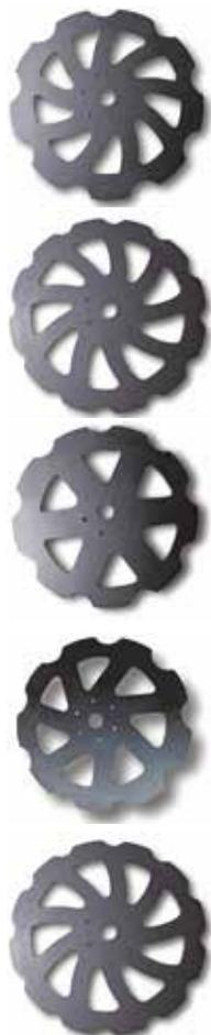
**Спиральный каток:** классический, самый распространенный и популярный каток. Хорошо выравнивает гребнистую поверхность поля после прохода основных рабочих органов. При установке сразу после дисков, хорошо выравнивает набрасываемую дисками землю.
