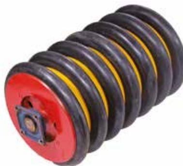
**Ш-каток и Т-каток:** в настоящее время приобретают популярность катки из колец прокатного швеллера, Ш-катки, и катки из колец прокатного тавра, Т-катки. Эти катки могут быть одинарными, в таком случае для очищения катков между кольцами применяются чистики. Эти катки также могут быть двойными, в этом случае происходит самоочищение катков.
